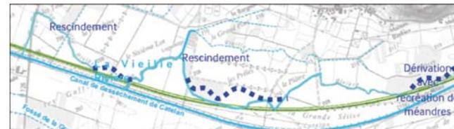
*Dérivation de la Vieille Rivière – Schéma de principe*
